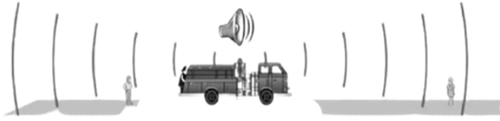
أ - السيارة في حالة سكون كلا الراصدين على الجانبين يستلمان من منبه السيارة الموجات الصوتية بنفس التردد والطول الموجي
