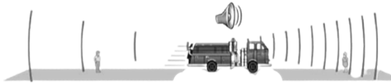
ب - السيارة في حالة حركة باتجاه الراصد على جهة اليمين لذا سيستم تردادات اعلى وطول موجي قصير لصوت المنبه بخلاف الراصد في الاتجاه الاخر
